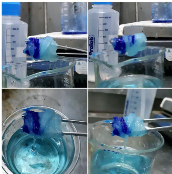
Figura 6 Retirada das fibras de Rayon preparadas a partir de polpa de celulose obtida pela reciclagem de bitucas de cigarro.
