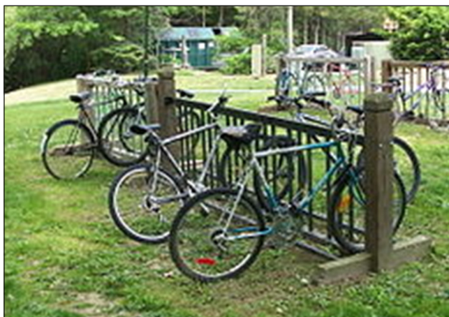
Figura 5.5 Estrutura de paraciclo em grelha. Fonte: Internet.
