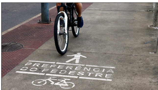
Figura 2.5 Calçada para uso compartilhado (sem separação) de pedestres e bicicletas. Fonte: Internet.
