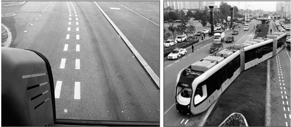
Figura 2.24 Dispositivo ótico embarcado e veículos operando com base em faixas tracejadas no pavimento. Fonte: Internet.
