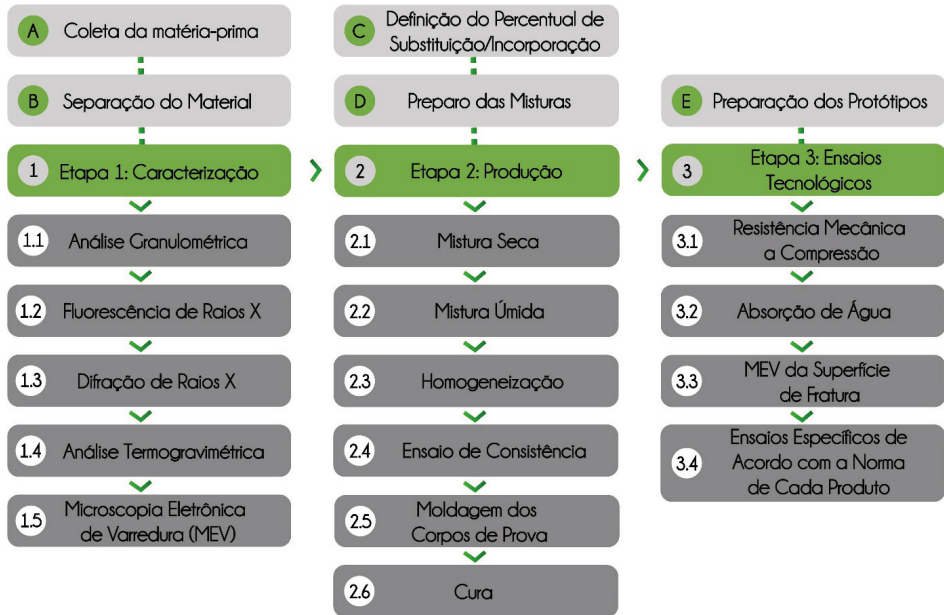
Figura 4 Fluxograma dos procedimentos de pesquisa experimental para materiais de base cimentícia. Fonte: Elaboração própria.
