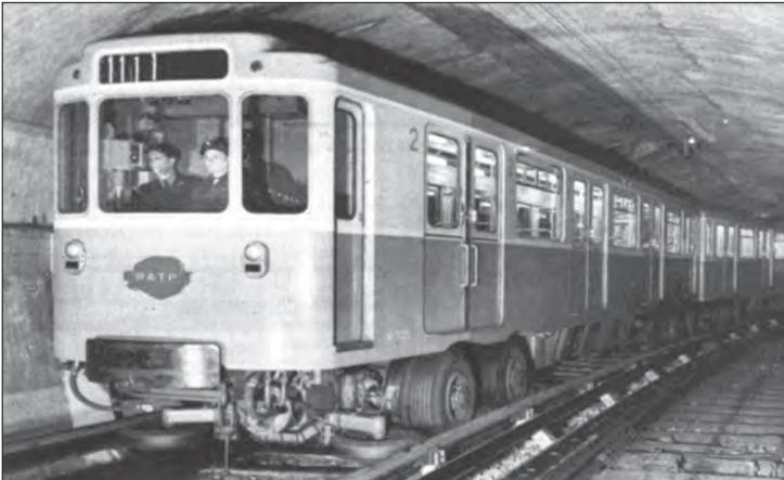
**Figura 3.53** Metrô sobre rodas pneumáticas em Paris, França. *Fonte:* Vuchic (1981).
