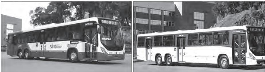
**Figura 3.31** Ônibus urbano com 15 metros de comprimento. *Fonte:* Fotos feitas pelos autores.
