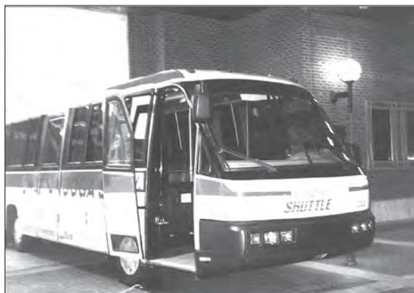
**Figura 3.27** Ônibus movido a baterias elétricas em Chattanooga, Estados Unidos. *Fonte:* Foto feita pelos autores.
