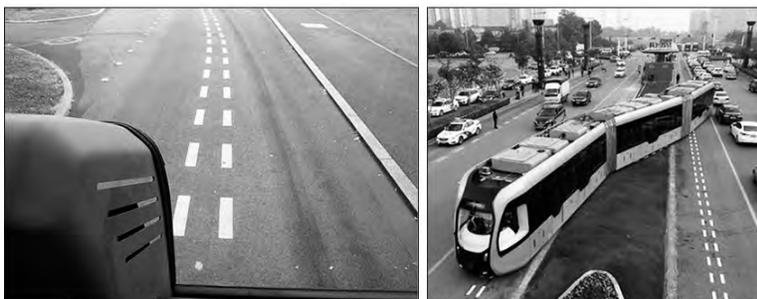
**Figura 3.86** Dispositivo ótico embarcado e veículos operando com base em faixas tracejadas no pavimento. *Fonte:* Internet.
