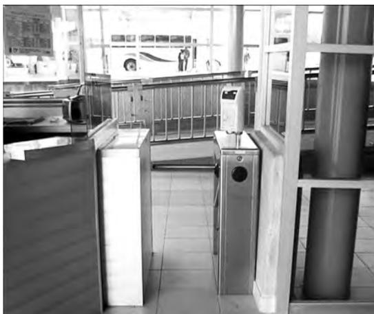
**Figura 10.5** Catraca com três braços num terminal de ônibus da cidade de León, México, acoplada a validador para cartão inteligente. *Fonte:* Foto feita pelos autores.
